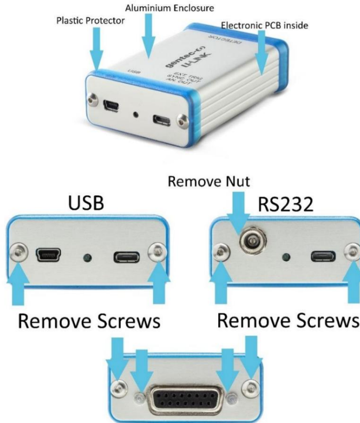
Şekil 7. U-LINK'in geri dönüşüm ve atık bertarafı için açılması
